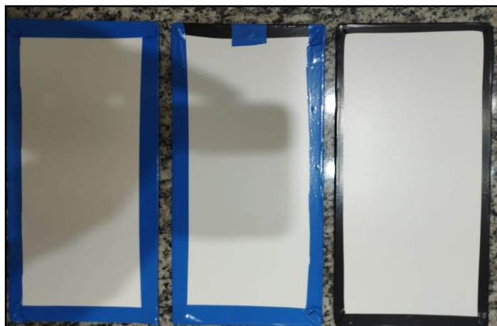
Foto 3 – Chapas após 336 horas em exposição
